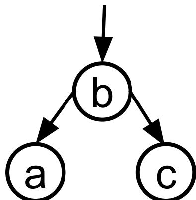
Como (raiz.dir == null e  $1 < 2 < 5$ ), basta inserir o 5 à direita da raiz, substituir o 2 na raiz e o 1 à esquerda da raiz
